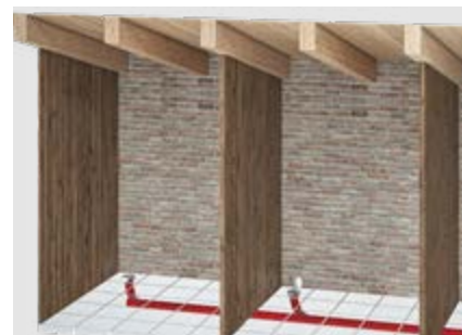
C Botola di raccolta a pavimento
